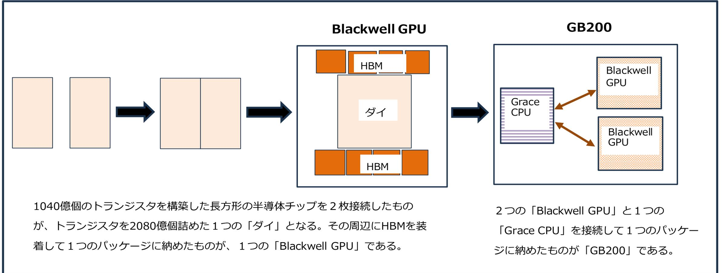
1040億個のトランジスタを構築した長方形の半導体チップを2枚接続したものが、トランジスタを2080億個詰めた1つの「ダイ」となる。その周辺にHBMを装着して1つのパッケージに納めたものが、1つの「Blackwell GPU」である。
