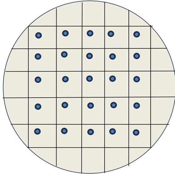
DRAM（DDR5）の回路を描き込んだシリコンウェハ上にエッチングで貫通電極を形成する。
